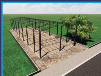
Etapa 1 Montagem da estrutura metálica base “esqueleto”. (Equipe AMC)
